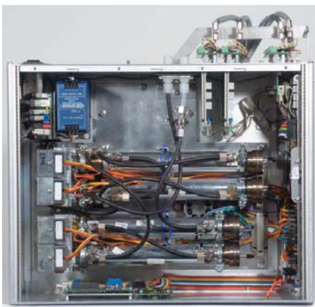
Innenansicht, zeigt 4 NDIR-Bänke, Thermostatisierung (Abdeckung entfernt), analoge und Relaisausgänge, digitale Eingänge, serielle Schnittstellen und Schraubklemmoptionen.
